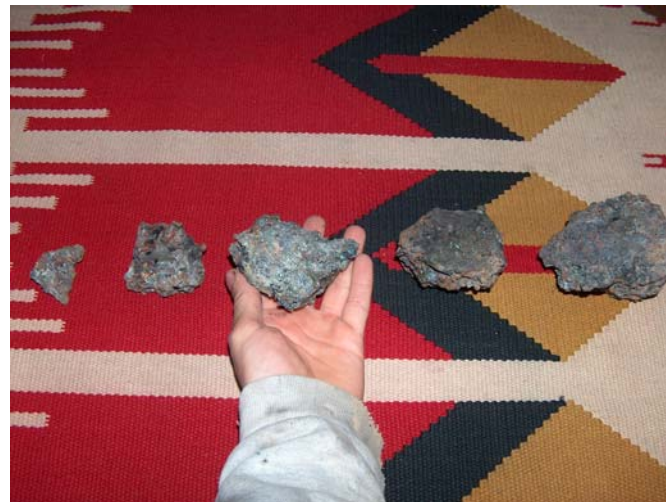
17. ábra: További sikeres próbaolvasztások vasbucái [4]
