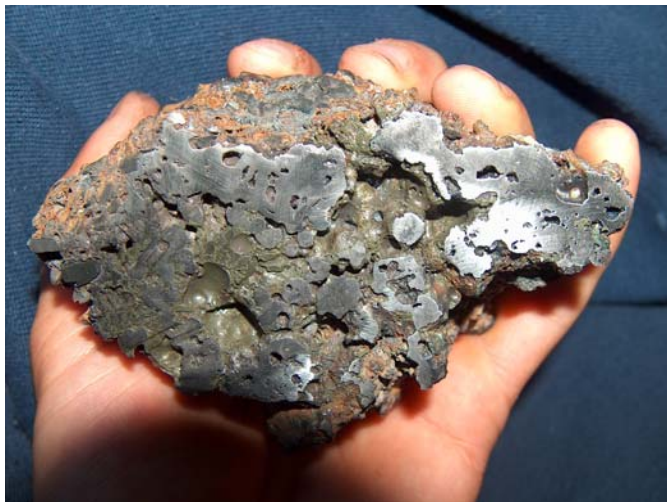
16. ábra: A hatodik próbaolvaszással kapott vasbuca keresztmetszete [4]
