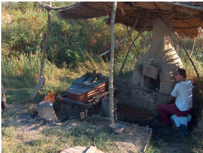
10. ábra: Próbaolvasztás a fajszi típusú bucakohóban [4]
