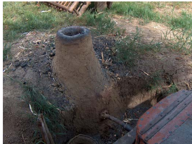
11. ábra: A fajszi típusú bucakohó szemből [4]
