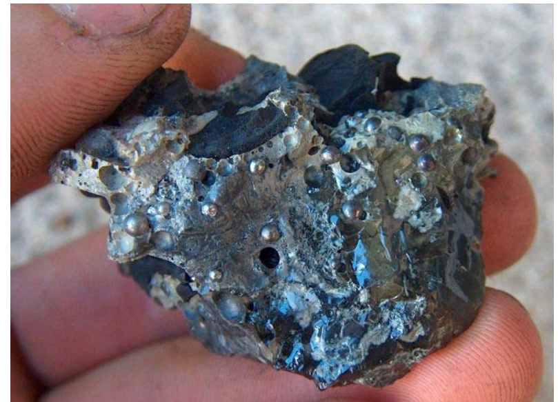
15. ábra: A buca kialakulásának kezdeti szakasza, ahol a salakban kivált vasgolyók még nem hegedtek össze [4]
