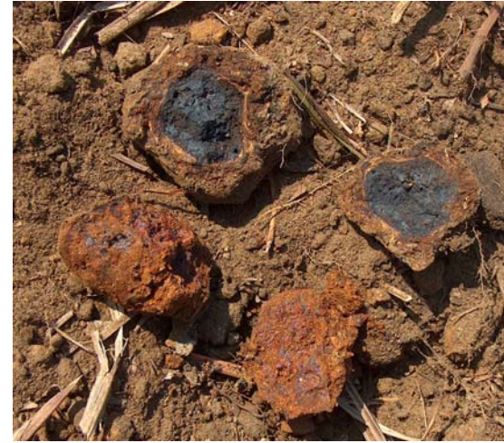
7. ábra: Jó (felül) és rossz (alul) minőségű fancieskai aprított gyevasérc törete [4]
